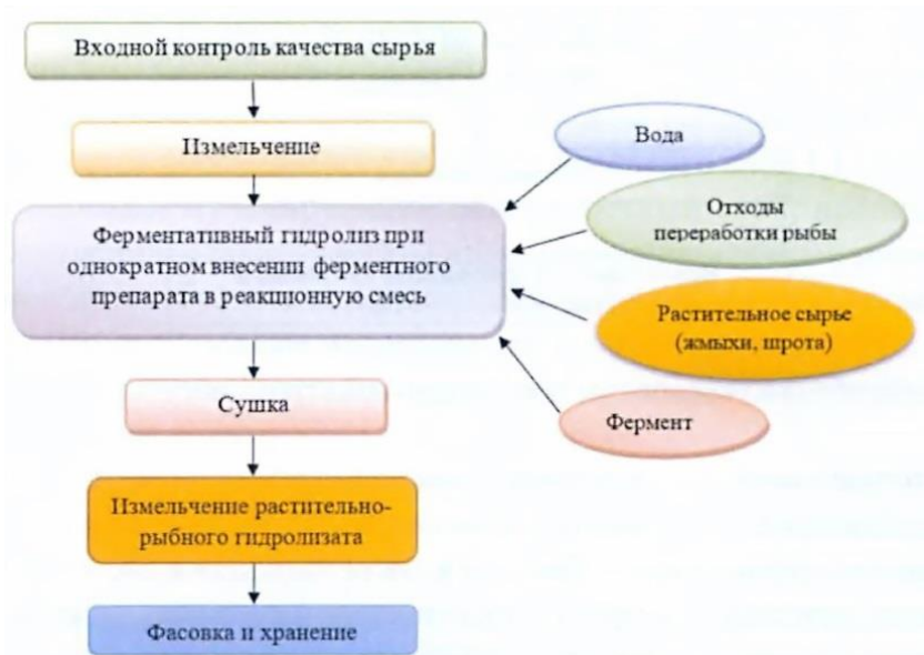
Структурная схема получения растительно-рыбного гидролизата из растительного сырья (шротов, жмыхов) и отходов переработки рыбы
