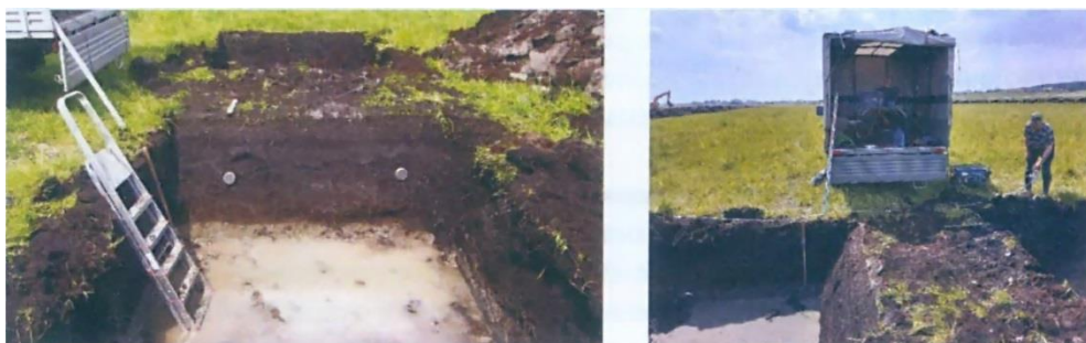
Определение параметров радиосигнала при прохождении через почвогрунты на мелиоративной системе Волма
