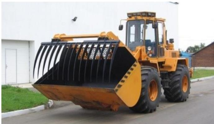
**Агрегат для закладки на хранение и выгрузки кормов из хранилищ АЗВК 352С-02**
